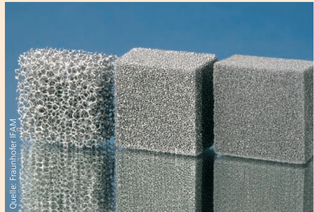
Muster von biofunktionalisierbaren metallischen Schäumen mit unterschiedlicher Porengröße
